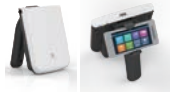
左：RFIDハンドリーダー「UF-2200」 右：スマートデバイスを取り付けた時
