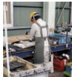
MFPの手分解作業
