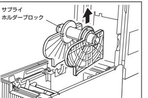
3 左側サプライホルダーのロックレバーを解除し、サプライシャフトから左側サプライホルダーを取り外します。
