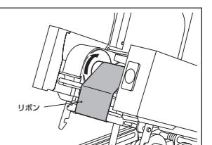
6 リボンカバーを静かに下ろし、「カチッ」と音がするまで確実に閉めます。
