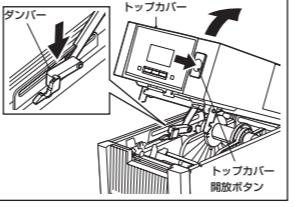
2 用紙およびリボンの経路図は、トップカバーの内側に貼付されていますので参考してください。
