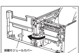
2 剥離ユニットオープンレバーのPUSHと印刷されたラベル部を押し下げ、剥離ユニットを開きます。
