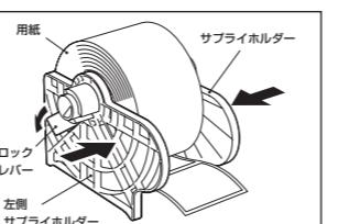
6 用紙をセットしたサプライホルダーブロックを、用紙収納部の輪受けに乗せます。
