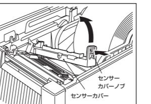
2 センサーカバーノブをつまみ、左に押しながら引き上げてセンサーカバーを左側に全開にします。
