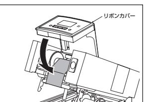
7 トップカバーを少し持ち上げてロックを解除してから静かに下ろし、トップカバー前面を両手で「カチッ」と音がするまで両手で押して確実に閉めます。
