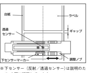
5 調整ノブを動かし、上センサーマークの○を下センサーマークの●に合わせます。
