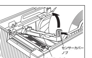
8 用紙の先端が用紙発行口より少し出る位置まで用紙を引き出し、左右の用紙ガイド用紙の幅にぴったり合わせます。
