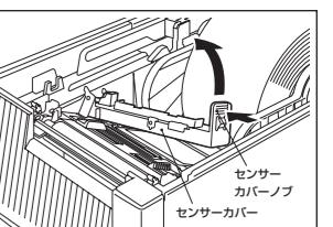
2 センサーカバーノブをつまみ、左に押しながら引き上げてセンサーカバーを左側に全開にします。
