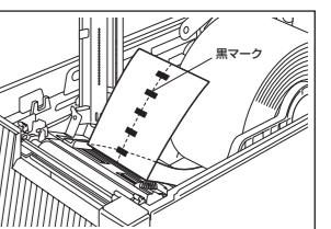
4 調整ノブを動かし、黒マークの中心線上に下センサーマークの●を合わせます。
