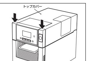
8 リボンのセット直後、トップカバーを閉めてそのまま印字を開始するとリボンにシワが発生して印字品質が損なわれる可能性があります。このような場合は、トップカバーを閉めた後、[FEED]キーを押して10～20cm程度用紙を搬送してから印字を開始してください。用紙とリボンの搬送が安定してリボンのシワの発生を抑えることができます。
