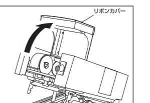
3 未使用側(径の太い方)のリボンを、後方(下部)のガイドホイールとスプリングガイドホイールの間に取り付けます。
