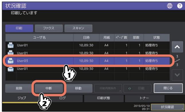
ジョブが中断されます。中断したジョブは順番が来ても印刷されず、後続のジョブが印刷されます。
