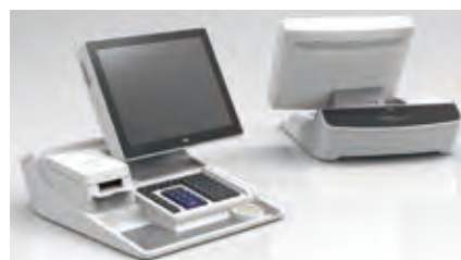
制御部一体ハイスペック15型ディスプレイ・キーボード・客面表示・プリンター・ベース部などを自由に組み合わせ、さまざまな運用形態に対応します。特にプリンターは、お客様側にレシートが出る向きにも設置でき、対面式セミセルフとしてもご利用いただけます。
