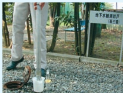
地下水の採水作業 (三島)
