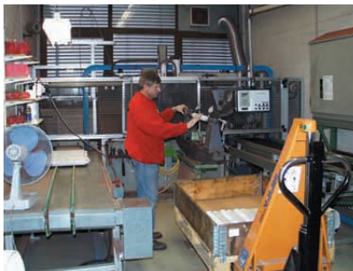
定着ローラーの再コーティング設備と仕上がり品の検査
