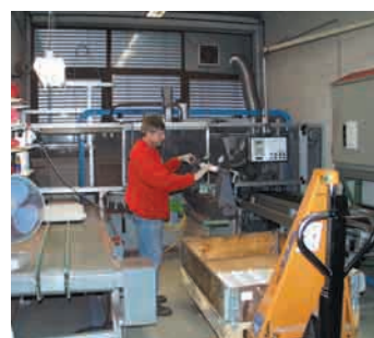
定着ローラーの再コーティング設備と仕上がり品の検査
