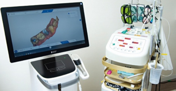
▲精度の高い診療を実現するため、最新の設備を多数導入。口腔内の撮影データを立体画像にしてモニターに映す口腔内スキャナー（左）と、「削らない治療、可能にするレーザー治療器
