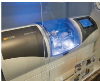
▲マイクロスコープで撮影した3Dデータを基に、セラミックスの人工歯を短時間で製作する「セレックシステム」
