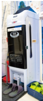
▲使用済みスリッパを紫外線殺菌するディスクベンサー。ボタンを押すと下から殺菌済みのスリッパが出てくる
