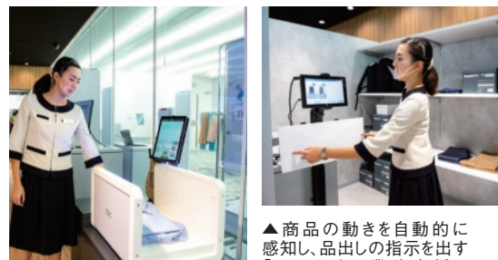
▲複数の商品を瞬時に読み取り、会計までできるRFIDセルフレジ
