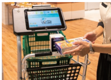
▲買物しながら商品登録できるカート型セルフレジ「ビビットカート」。会計機を使わず、カート上での決済も可能。買物客が自分のスマートフォンを利用する「ビビットスマホ」も展示
