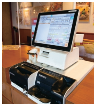
▲自動釣銭機付きのPOSレジ「QT-200」。お釣りの渡し間違いがないとスタッフにも好評だ
