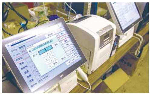
▲産直品に貼るラベルは生産者自らがラベルシステムを操作して出力 ▼システムレジスター「FS-3055」。狭い場所にも置けるコンパクトな設計
