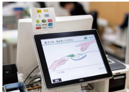
▲証明交付窓口で使用しているPOSレジ「QT-20」。対面式セルフレジとして運用され、ほとんどのキャッシュレス決済に対応。画面上で支払い方法を選ぶと操作方法が表示され、わかりやすいと好評だ
