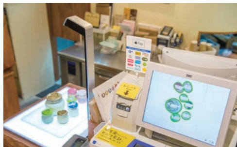
▲左側のカメラの下に置いた複数の商品を瞬時に識別し、右側のディスプレイに合計金額を表示する「ペーカリースキャン」
